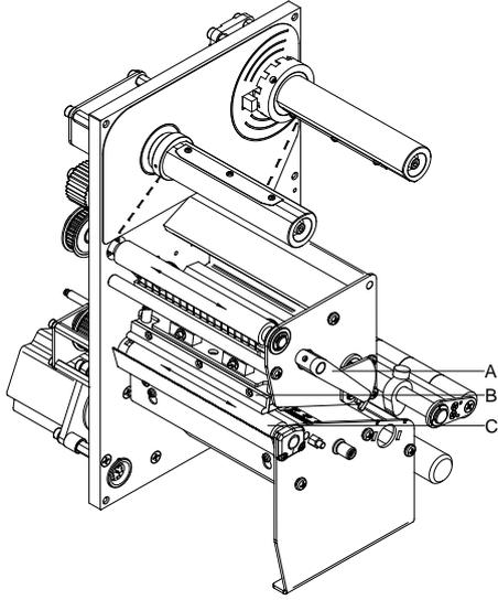
Baskı merdanesinin kirlenmesi, kötü bir baskı kalitesine ve malzeme taşımalarının sınırlandırılmasına neden olabilir.
