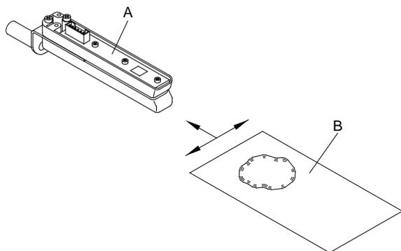
A célula fotoeléctrica pode ficar suja com o pó do papel. Isto pode comprometer a detecção das etiquetas.
