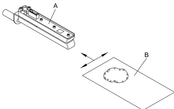
La fotocellula delle etichette può accumulare impurità a causa della polvere di carta. Questo può comprometterne il riconoscimento della parte iniziale delle etichette.
