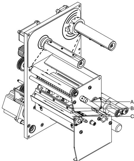
El ensuciamiento del rodillo de impresión puede repercutir en una mala calidad de impresión y además puede estropear el material de transporte.
