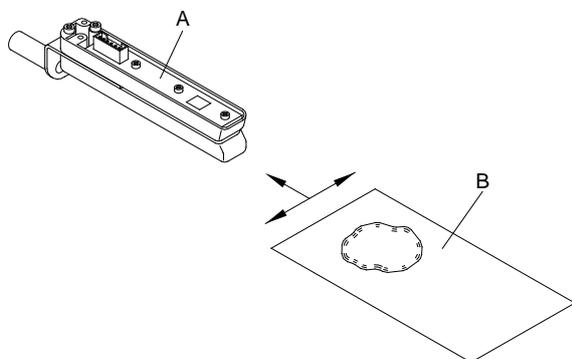
Die Etikettenlichtschranke kann durch Papierstaub verschmutzen. Dadurch kann die Etikettenabstastung beeinträchtigt werden.
