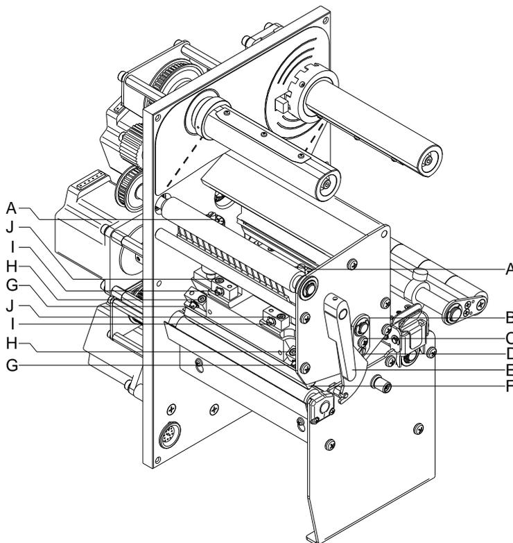
Para obtener una impresión de calidad, una característica importante es la posición del paralelismo de la línea de enfoque del cabezal de impresión en el cilindro de presión. Como la posición de la línea de enfoque del cabezal térmico de impresión sufre ligeras variaciones debidas a la fabricación, es de relativa importancia regular el paralelismo tras un cambio del cabezal de impresión.
